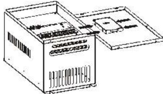
图3-12 机型B操作面板及连接线的安装图
